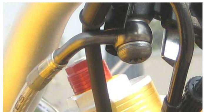
**Armaturenkabel links (5):** Die beiden Kabel der linken Schaltereinheit und des Zündschlosses aus dem rahmenfesten Kabelbinder lösen und mit dem beiliegenden, kleinen, Kabelbinder bündeln. Das Kabel zum Zündschloss mit dem großen Kabelbinder, wie abgebildet, an der linken Zündschlossbuchse befestigen.
